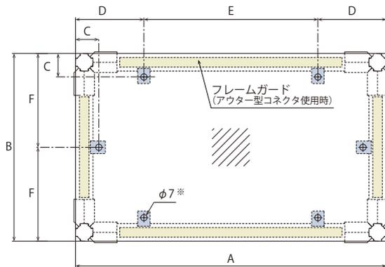
※パネルの表面から固定する場合、ボルトの種類、サイズに合わせて穴をあけてください。
